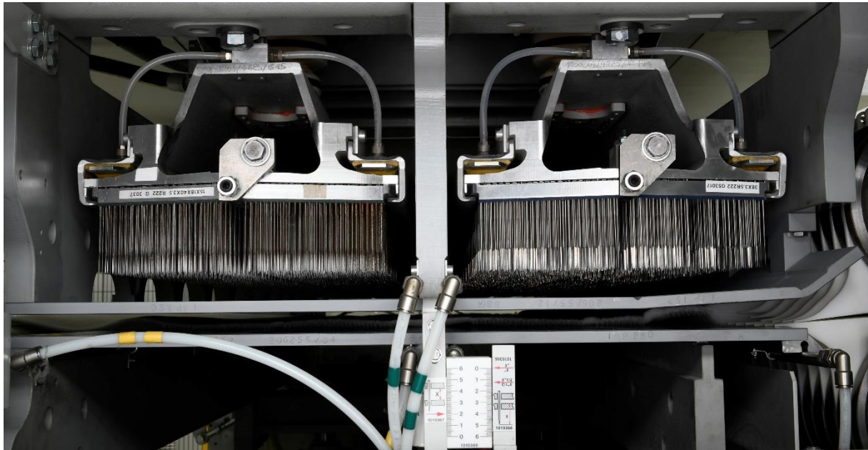
SFD-System (Self-Feeding Device) bei einer Vorvernadelungsmaschine für die Verarbeitung einer Vielzahl an Faserfloren.
