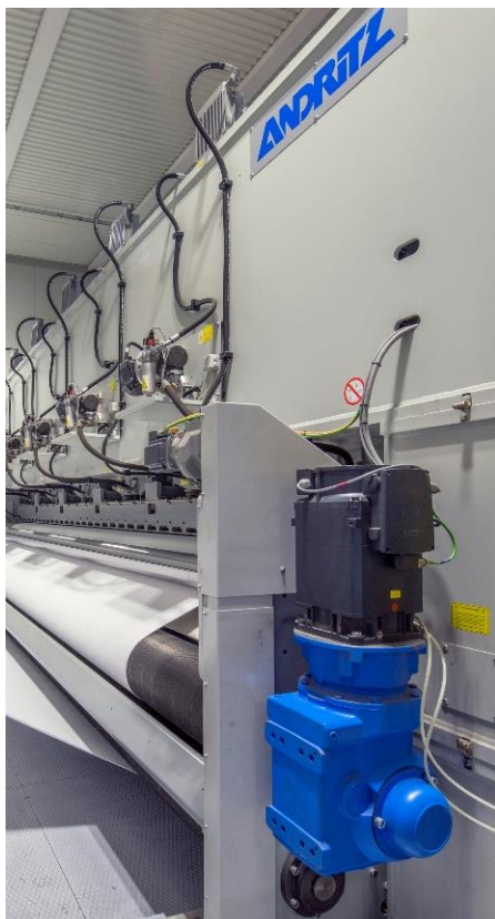
Nadelmaschine mit integrierter Zeta-Vliesstrecke
